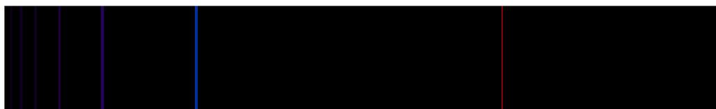
Figure 6.4 – Spectre d'émission de l'atome d'hydrogène présentant 6 raies caractéristiques :  $\lambda_{rouge} = 656,2 \text{ nm}$ ,  $\lambda_{bleu_1} = 486,1 \text{ nm}$ ,  $\lambda_{bleu_2} = 434,0 \text{ nm}$ ,  $\lambda_{violet_1} = 410,1 \text{ nm}$ ,  $\lambda_{violet_2} = 396,9 \text{ nm}$ ,  $\lambda_{violet_3} = 388,9 \text{ nm}$  et  $\lambda_{violet_4} = 383,5 \text{ nm}$
